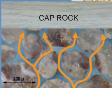
Figura 1 CO 2 injectat, care este mai ușor decât apa, are tendința de a se ridica dar ascensiunea sa este oprită de rocile impermeabile acoperitoare.
