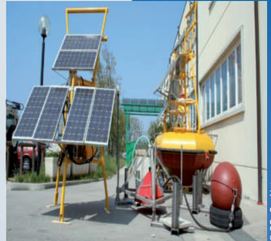
Figura 2 Geamandură de monitorizare cu panouri solare pentru obținerea energiei și dispozitiv de captare a gazului de pe fundul mării.
